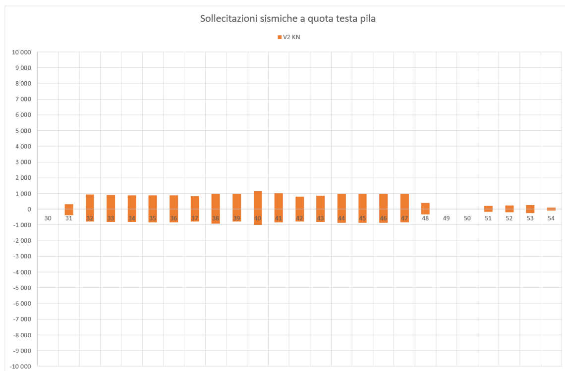
Figura 120 – Taglio longitudinale V2, modello SIS-LB, 30mm, analisi TH
