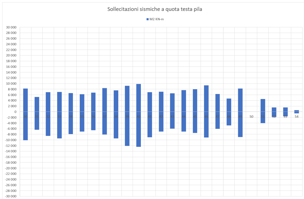
Figura 67 – Momenti trasversali M2, modello SIS-UB, 30mm, analisi TH
