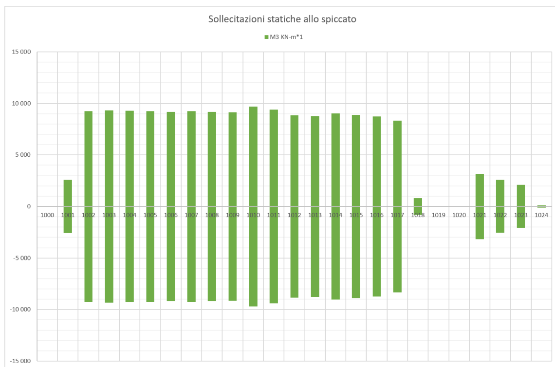
Figura 178 – Momenti longitudinali M3, modello ESE-UB, Vento a ponte carico caratteristico (Q5PC)
