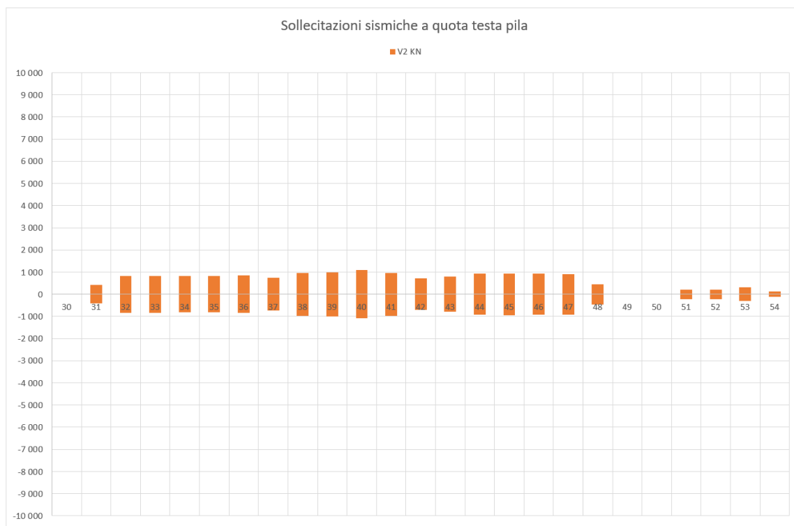
Figura 117 – Taglio longitudinale V2, modello SIS-UB, 30mm, analisi RSA Caso A (Normativa)
