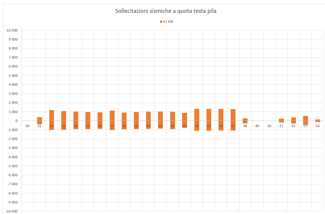
Figura 116 – Taglio longitudinale V2, modello SIS-UB, 20mm, analisi TH
