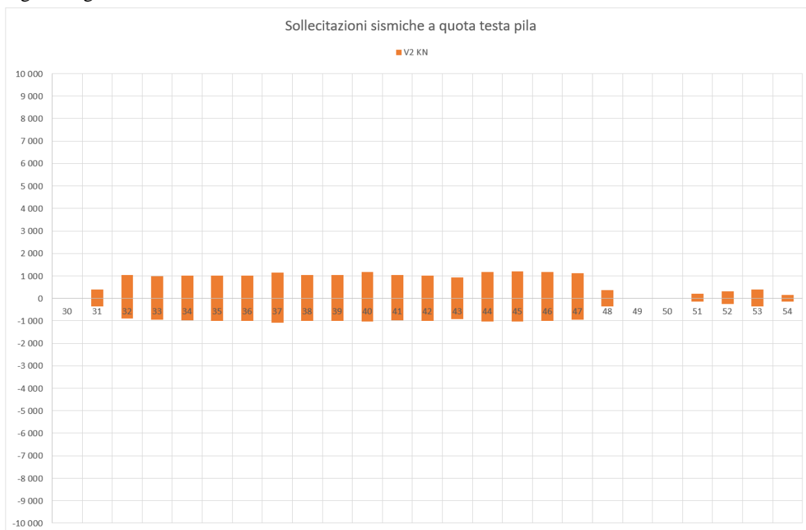
Figura 115 – Taglio longitudinale V2, modello SIS-UB, 30mm, analisi TH
