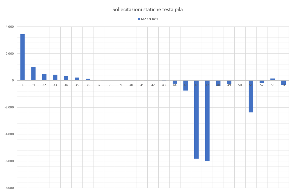
Figura 73 – Momenti trasversali M2, modello ESE-UB, Peso proprio caratteristico (G1)
