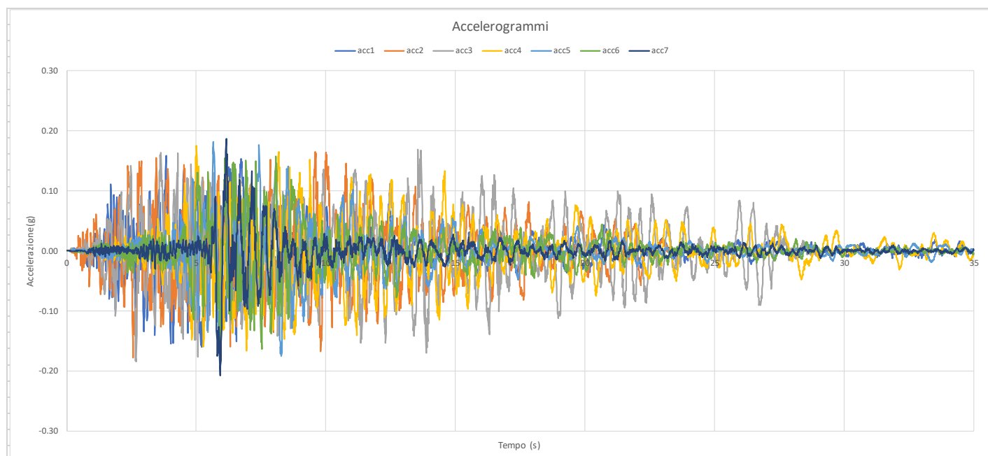
Figura 15 – Accelerogramma orizzontale Pila 14 – SLC
