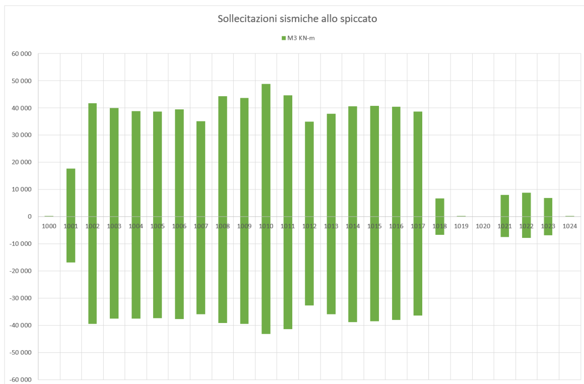
Figura 165 – Momenti longitudinali M3, modello SIS-UB, 20mm, analisi TH
