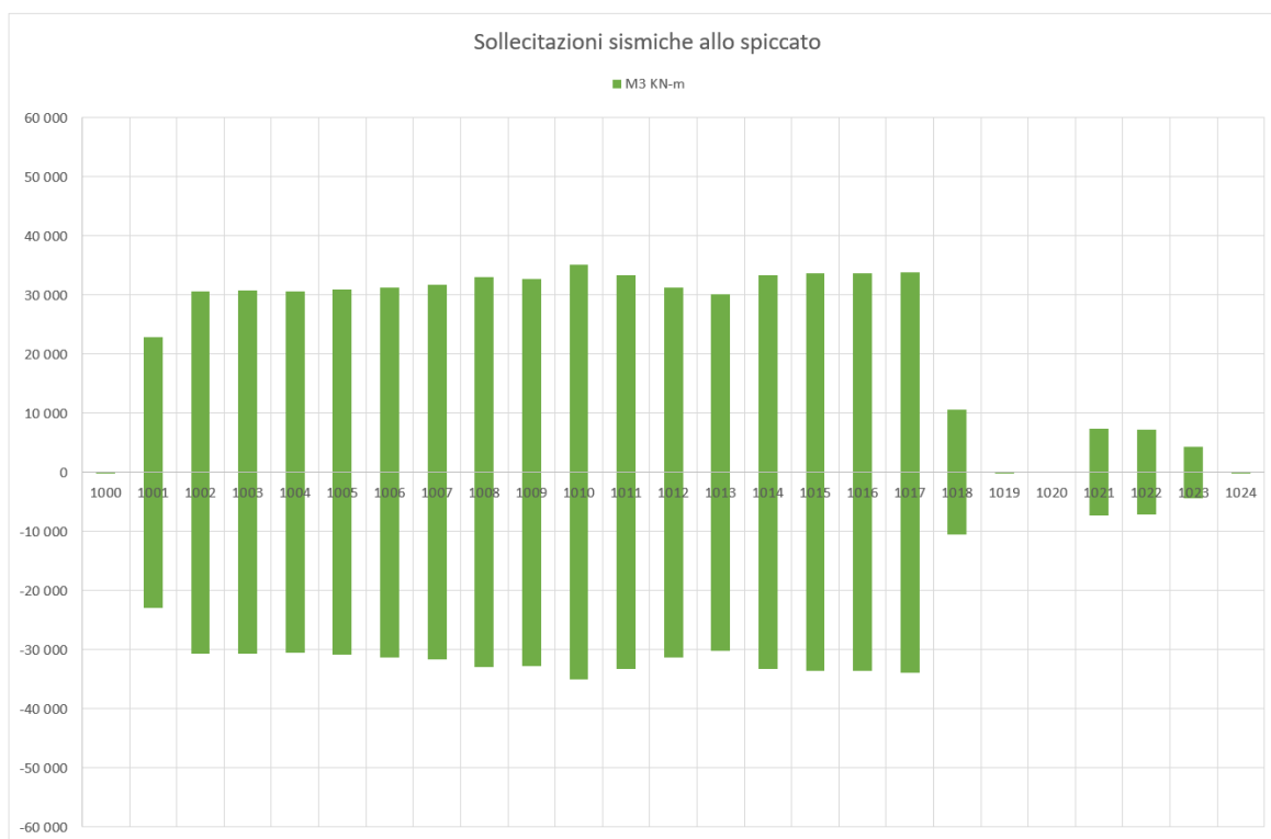
Figura 168 – Momenti longitudinali M3, modello SIS-UB, 30mm, analisi RSA Caso C (RSL P14+P3)
