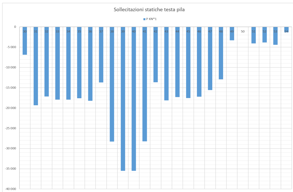
Figura 137 – Sforzo normale P, modello ESE-UB, Peso proprio caratteristico (G1)
