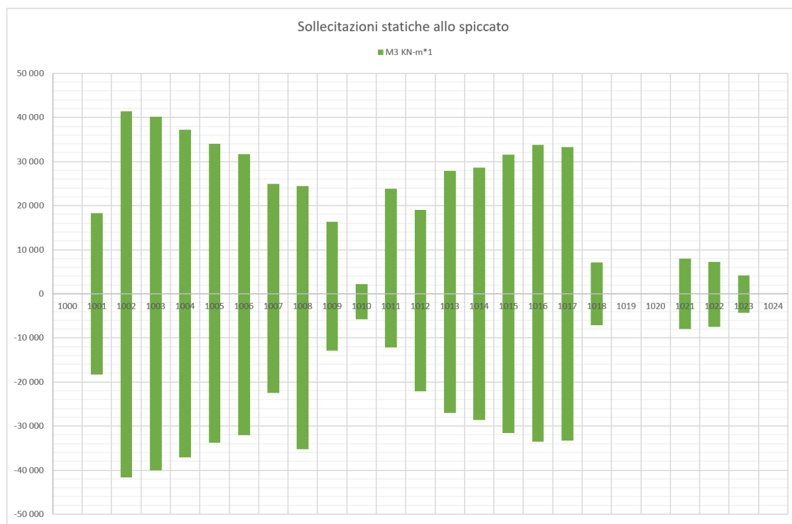
Figura 240 – Momenti longitudinali M3, modello ESE-UB, Stato Limite di Esercizio Frequente (SLEf)
