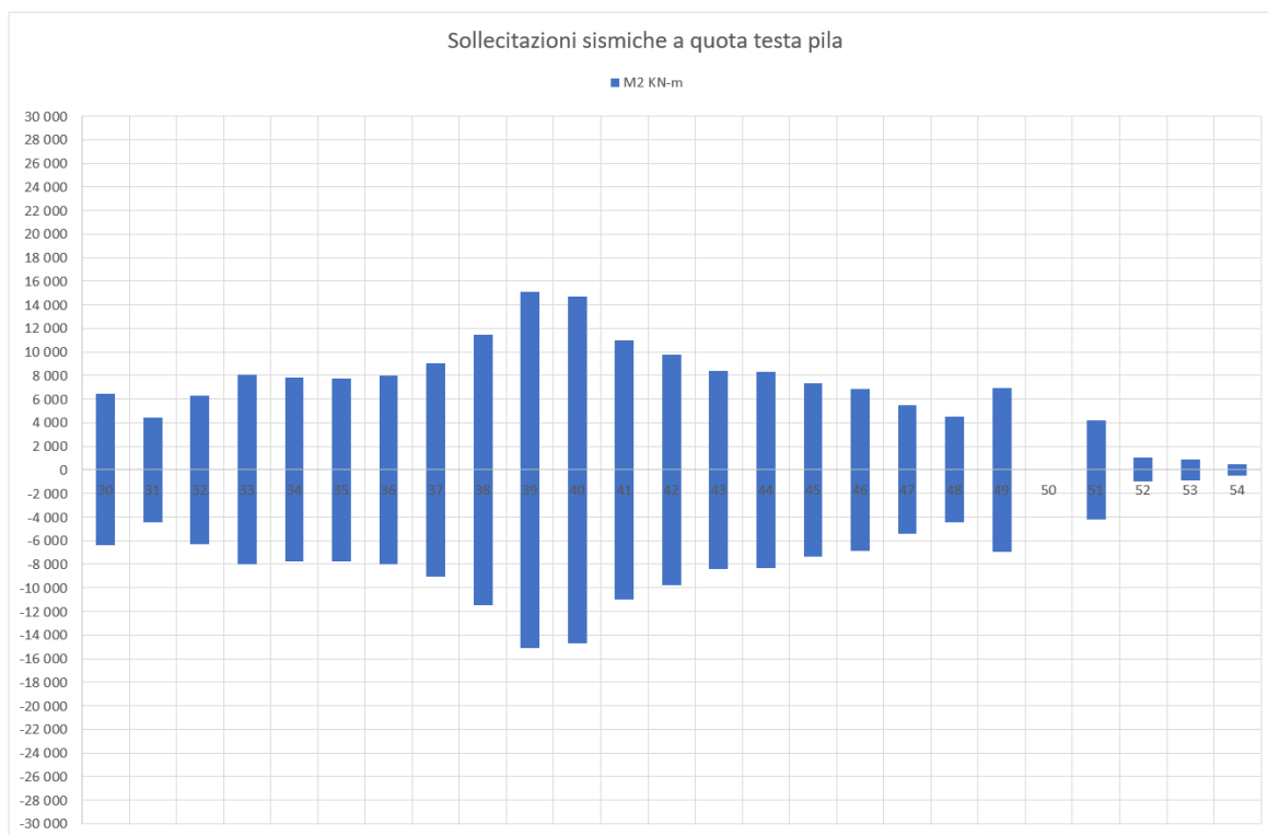
Figura 71 – Momenti trasversali M2, modello SIS-UB, 30mm, analisi RSA Caso C (RSL P14+P3)
