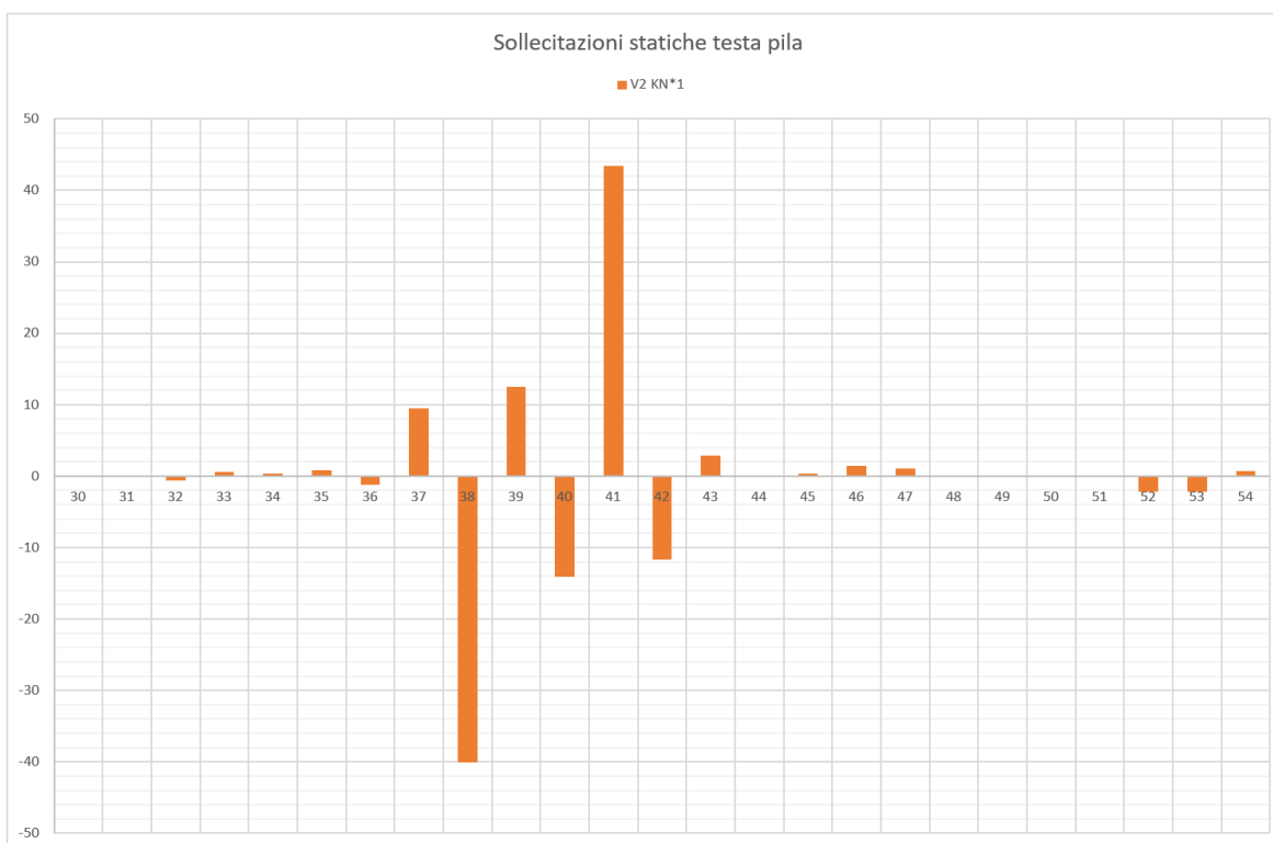
Figura 122 – Taglio longitudinale V2, modello ESE-UB, Permanenti portati caratteristici (G2)
