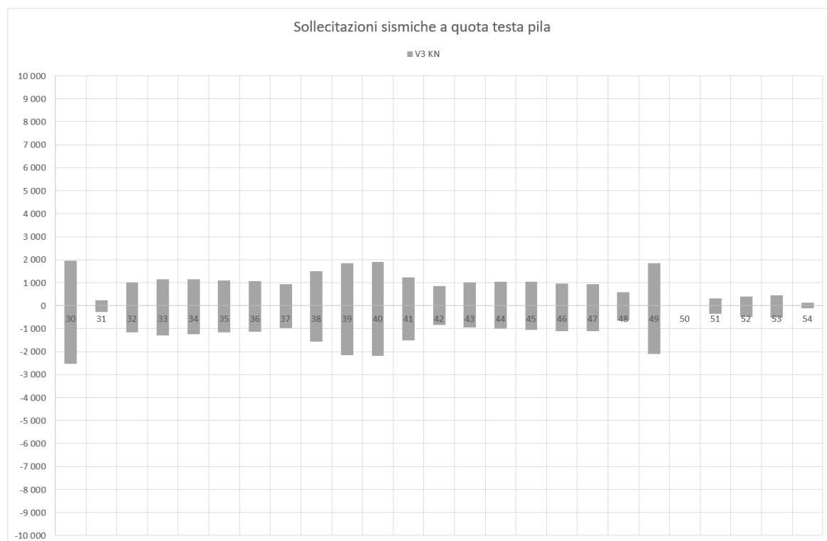
Figura 100 – Taglio trasversale V3, modello SIS-UB, 20mm, analisi TH
