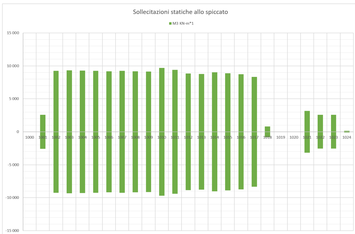
Figura 177 – Momenti longitudinali M3, modello ESE-UB, Vento a ponte scarico caratteristico (Q5PS)
